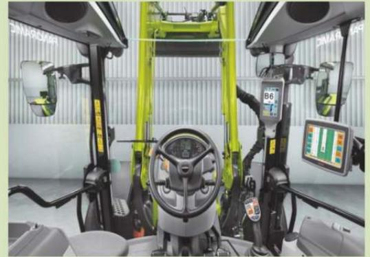
Modell übergreifend wird bei Claas der Kabinen/Bedienkomfort groß geschrieben. Wie zB. die vierfach voll gefederte Kabine, das neue CEBIS Touch-Display und das Panoramidach.
